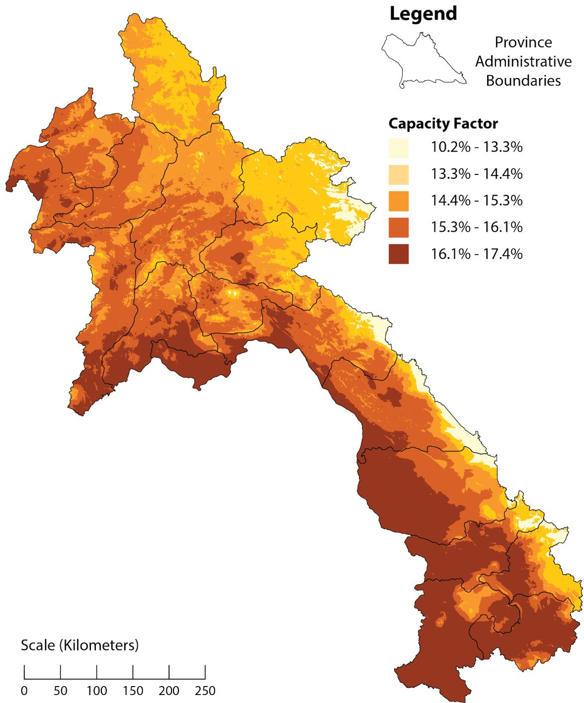
**FIGURE 4. MAP - CAPACITY FACTORS FOR REPRESENTATIVE SOLAR PV SYSTEM IN LAO PDR**
