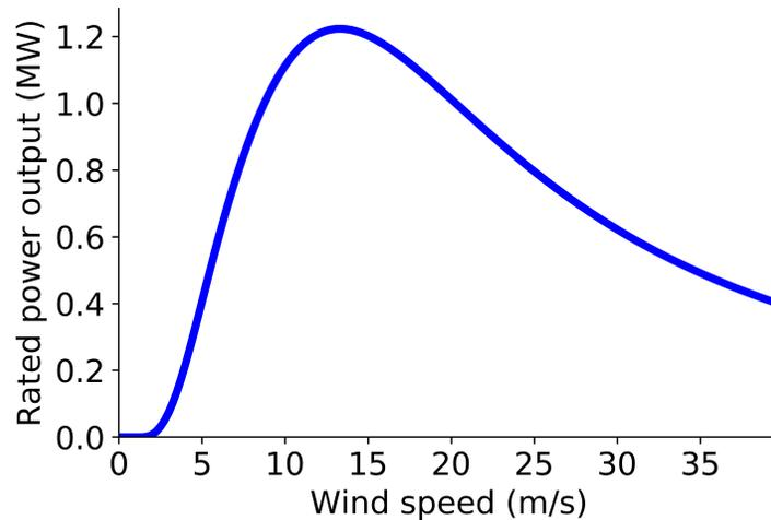
**FIGURE 5. POWER CURVE FOR REPRESENTATIVE WIND TURBINE IN LAO PDR**
