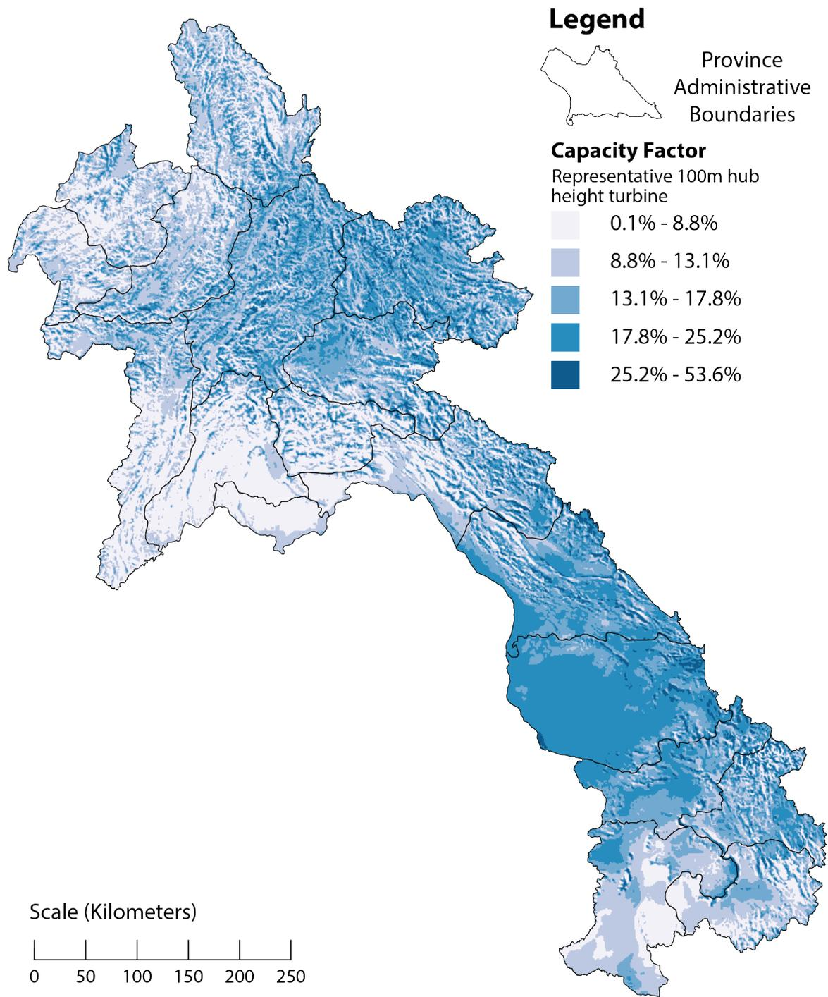
**FIGURE 6. MAP – CAPACITY FACTORS FOR REPRESENTATIVE WIND TURBINE IN LAO PDR**
